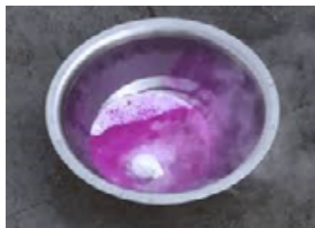
Слика 5.3. Натриумот реагира со водата и се добива натриум хидроксид. Кога во водниот раствор на натриум хидроксид ќе се додадат неколку капки индикатор фенолфталеин, растворот се обојува виолетово.
