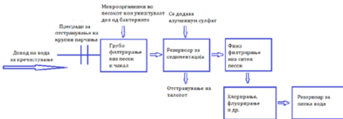
Слика 7.12. Шематски приказ на постројка за пречистување вода за пиење.
