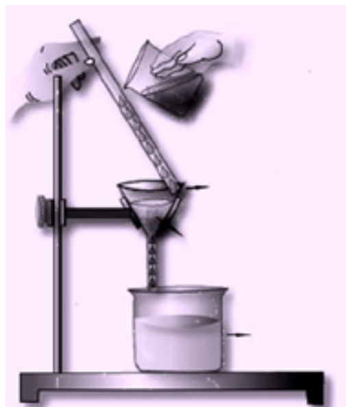
Слика 2.28. Прибор за филтрација. Низ филтер-хартијата минува бистрата течност, а на филтер-хартијата останува цврстата супстанца.
