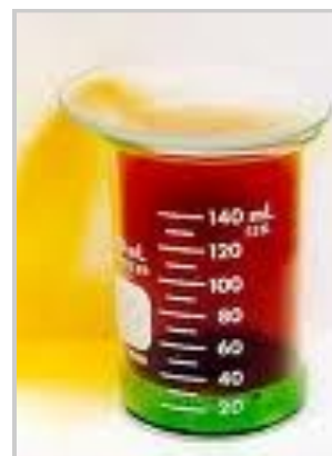
Слика 5.17. При реакцијата на металите со концентрираната азотна киселина се ослободува \text{NO}_2 , кој е црвено-кафеав гас.
