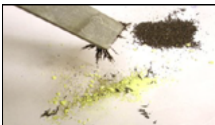
Слика 2.25. Железото може да се одвои од смесата врз основа на неговите магнетни својства.
