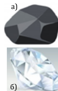
Слика 2.18. Графитот (а) и дијамантот (б) се алотропски модификации на јаглеродот.
