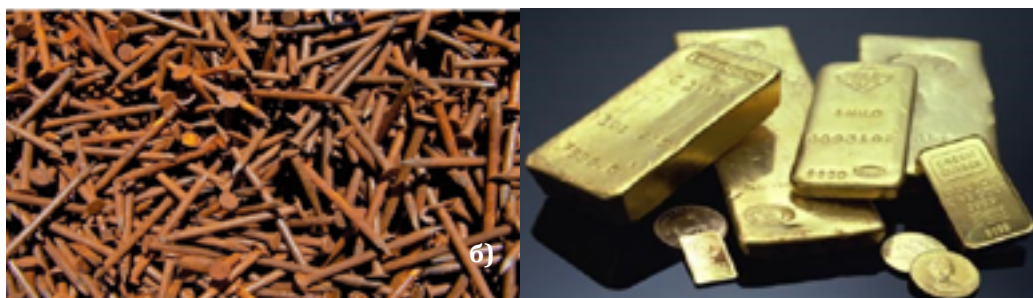
Слика 2.4. Железните предмети на воздух 'рѓосуваат (а), но не и оние од злато (б).
