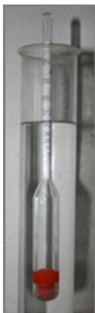
Слика 2.3. Густината на течностите се мери со инструмент што се нарекува ареометар.
