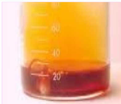
Слика 5.12. Концентрираната азотна киселина е кафеаво обоена од ослободениот \text{NO}_2 што се добива при нејзиното разложување.
