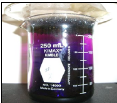
Слика 2.26. На собна температура, јодот е цврста супстанца со сива боја. Тој сублимира со виолетови пари, кои во допир со ладен предмет преминуваат во цврста состојба. Ова својство на јодот може да послужи за негово издвојување од смеси.
